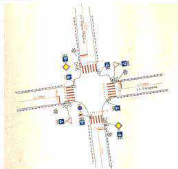
Режим работы светофорной сигнализации
